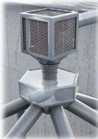
Drehverteiler, die rotierende Steuereinheit für die Verteilung auf bis zu 8 Zielpositionen
